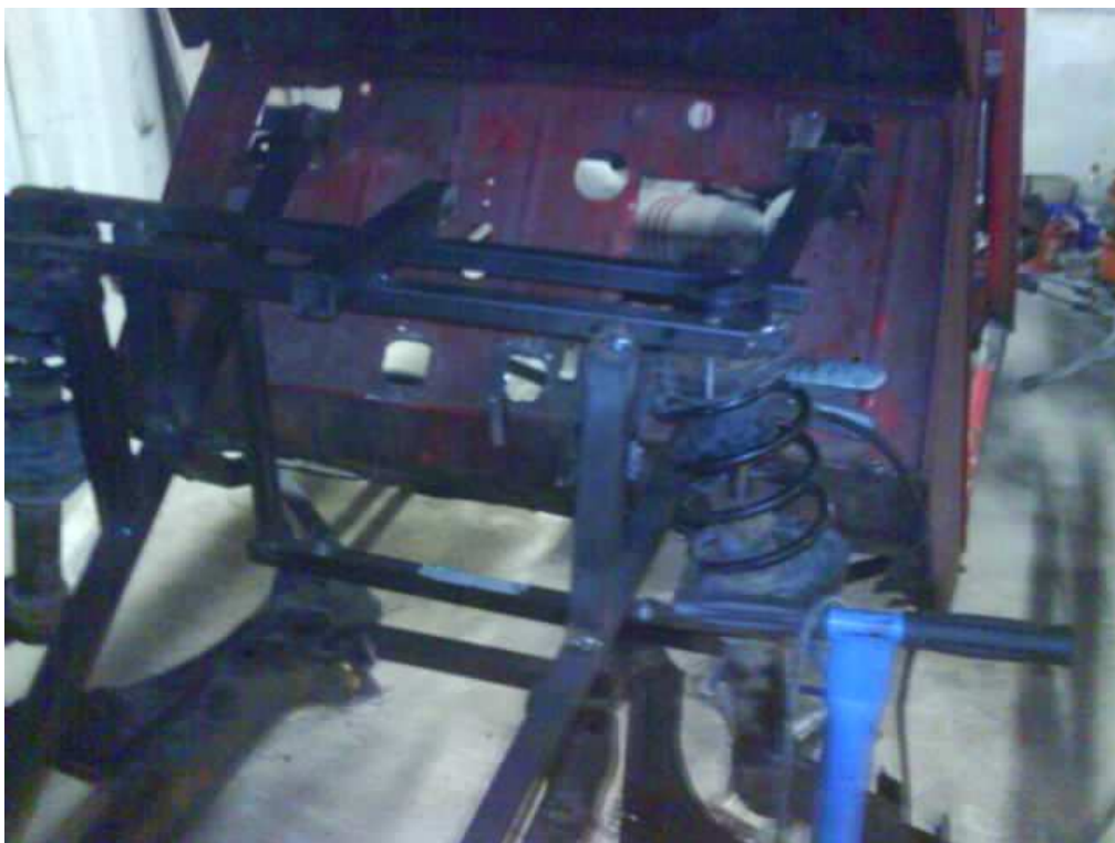
Einbau der Federbeine.
