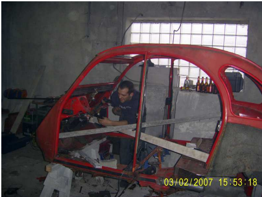
In den Aufbau wurde der neue Rahmen aus Stahlrohren eingearbeitet.
