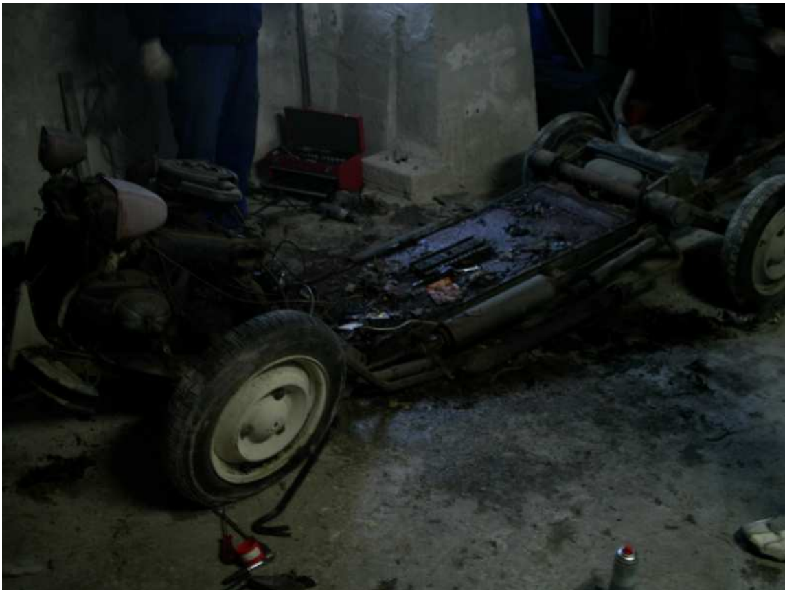
Beide Hauptträger durchgerostet.
