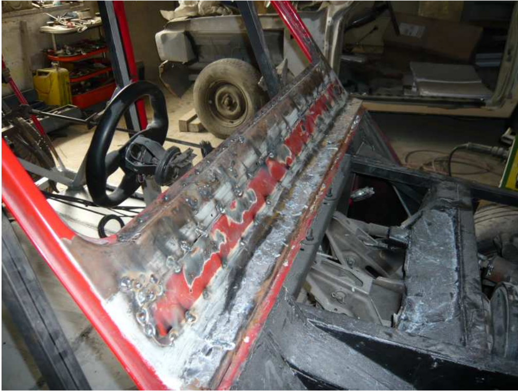
Die Luftklappe wurde verschlossen.
