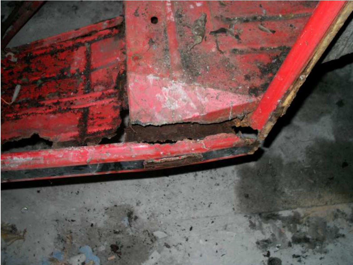
Das Bodenblech wurde komplett entfernt und die Schweller teilweise erneuert.
