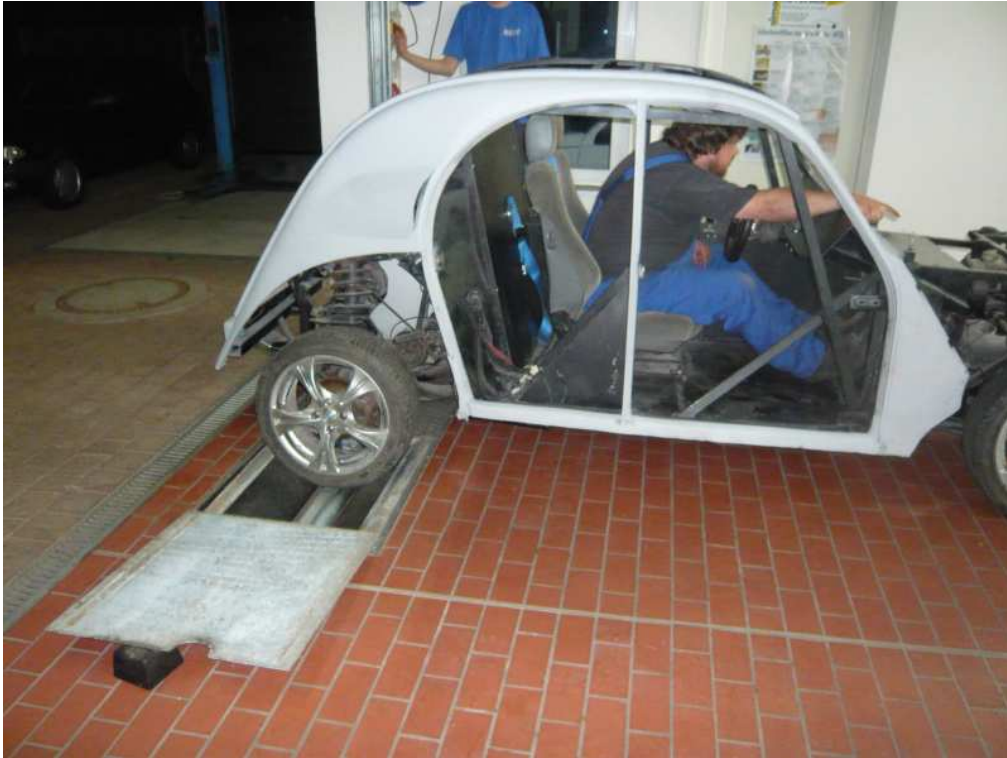
Einstellung der Bremskraftverteilung.
