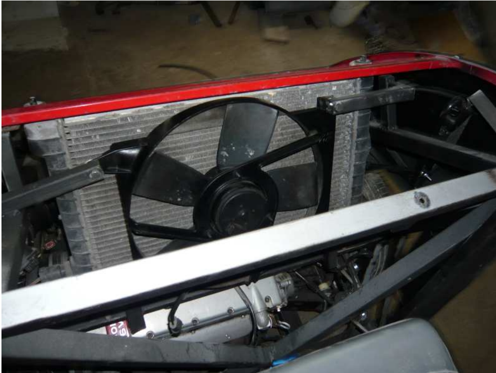
Einbau eines Zusatzlüfters vor den Kühler, welcher über den Motor verlegt wurde.
