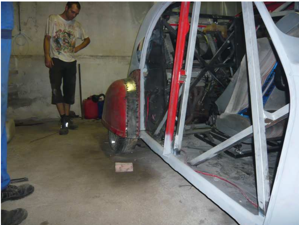
Verbreiterung der hinteren Kotflügel.
