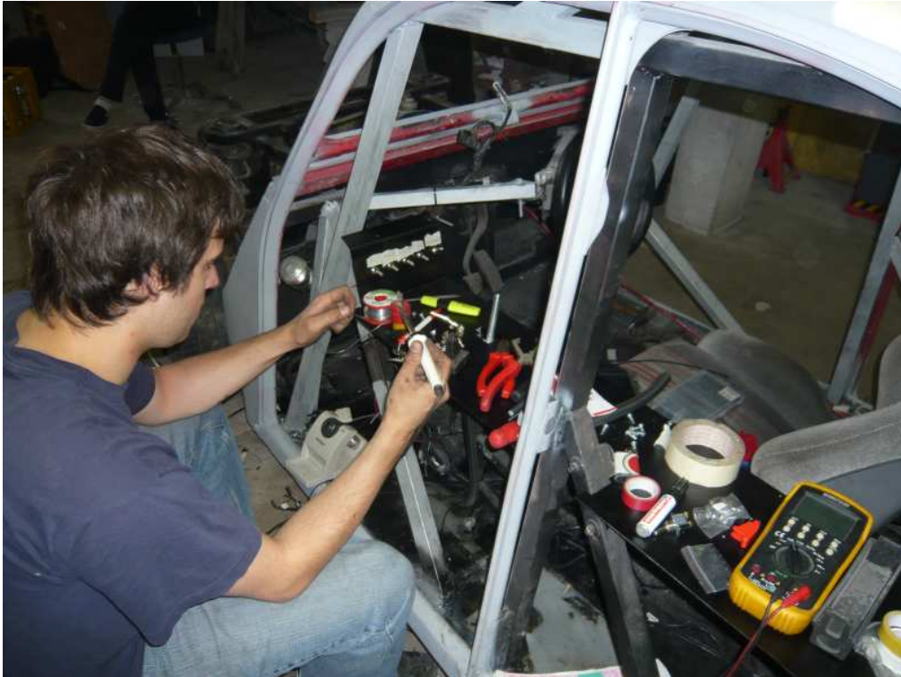
Einbau der Bordelektronik
