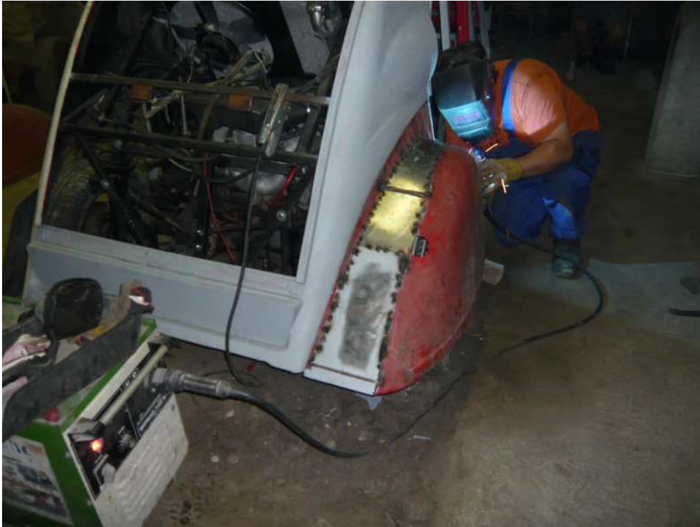
Verbreiterung der hinteren Kotflügel.
