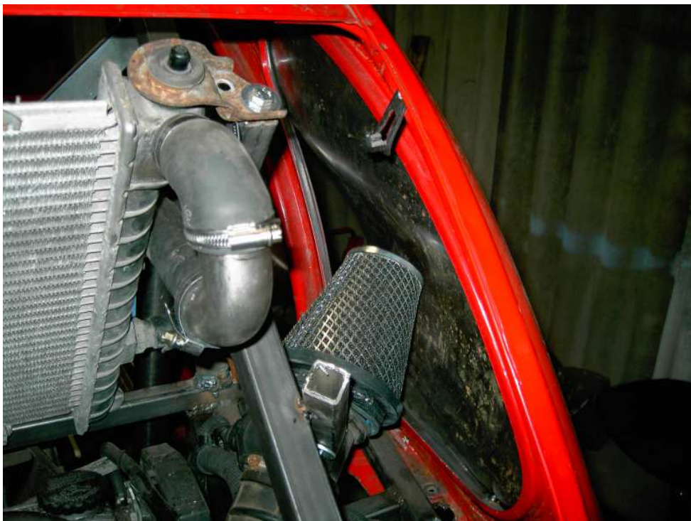
In die hinteren Fensterausparungen wurden Lufthutzen eingearbeitet.
