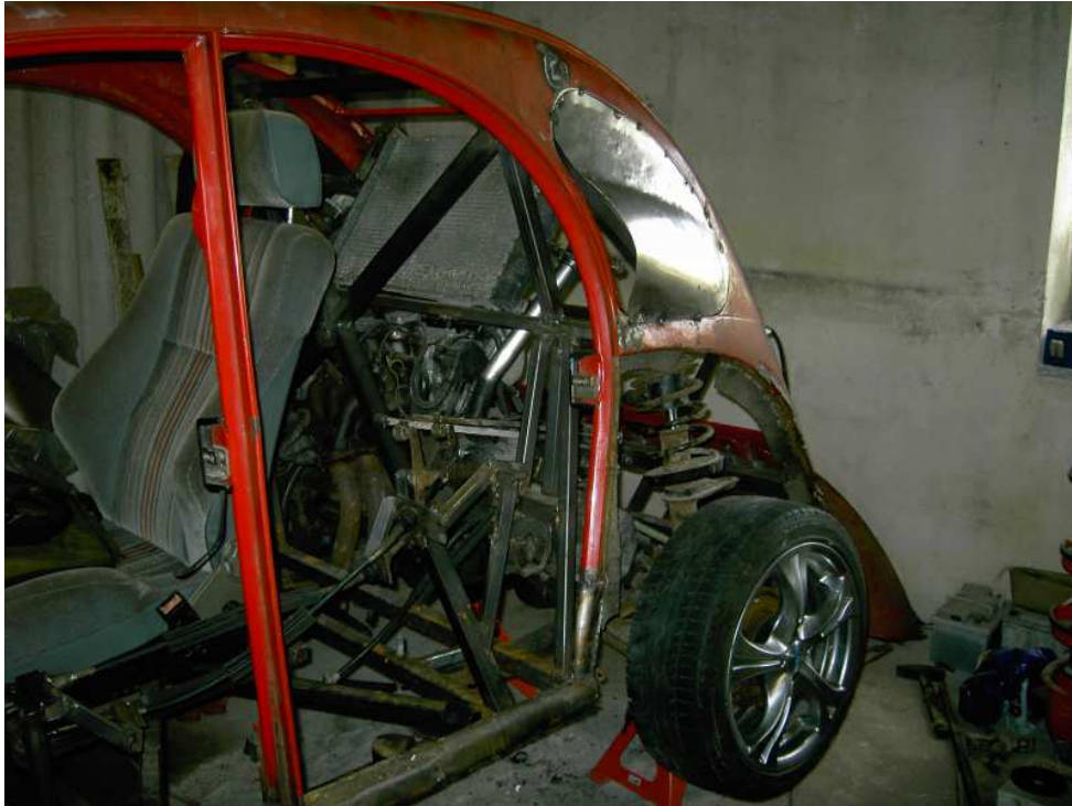
In die hinteren Fensterausparungen wurden Lufthutzen eingearbeitet.
