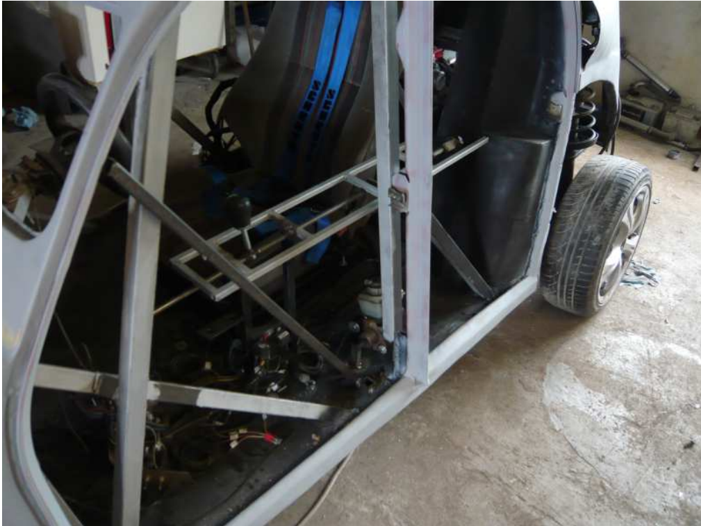
Einbau der endgültigen Schaltung.
