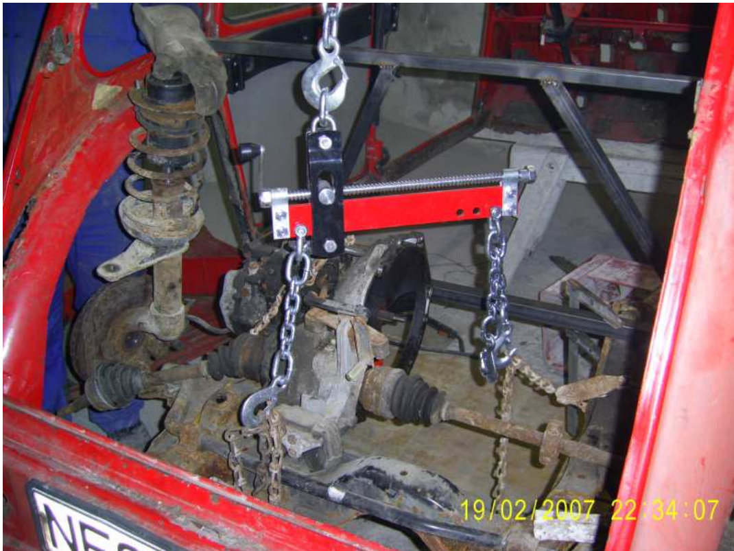
Einpassen des Getriebes und des Opel Hilfsrahmens.
