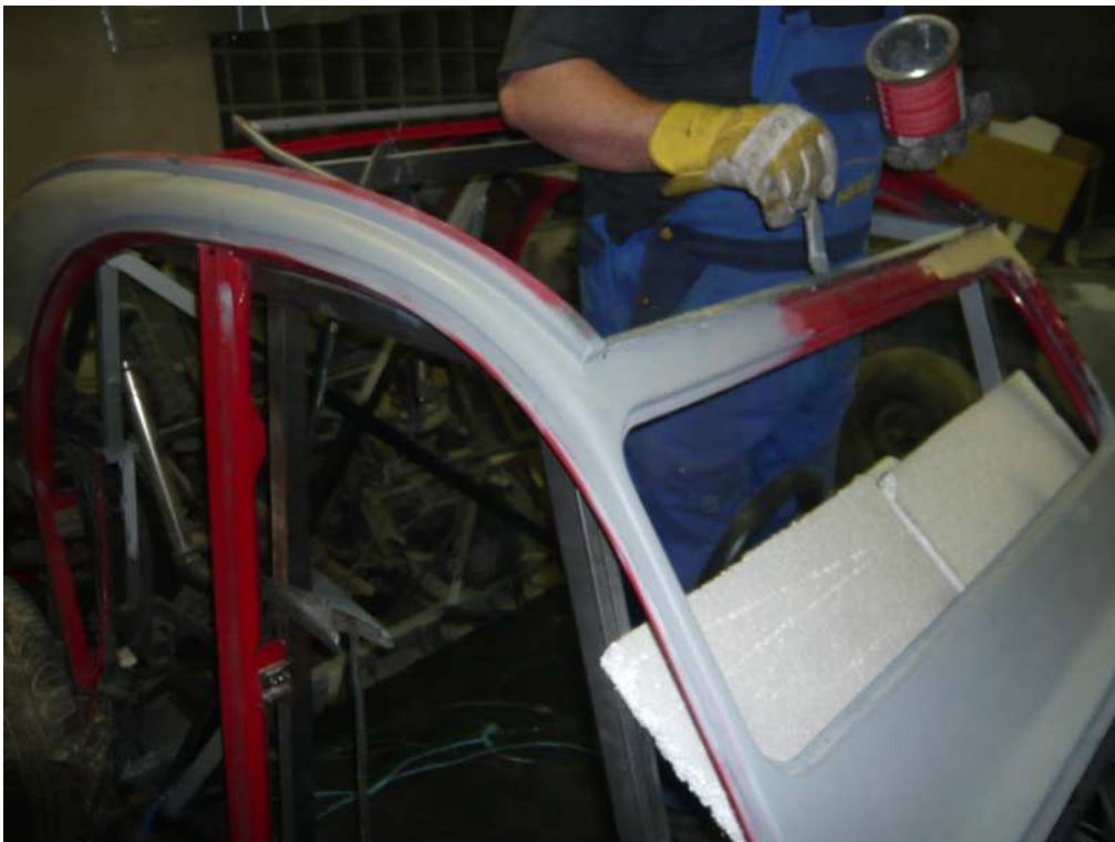
Die Luftklappe wurde verschlossen.
