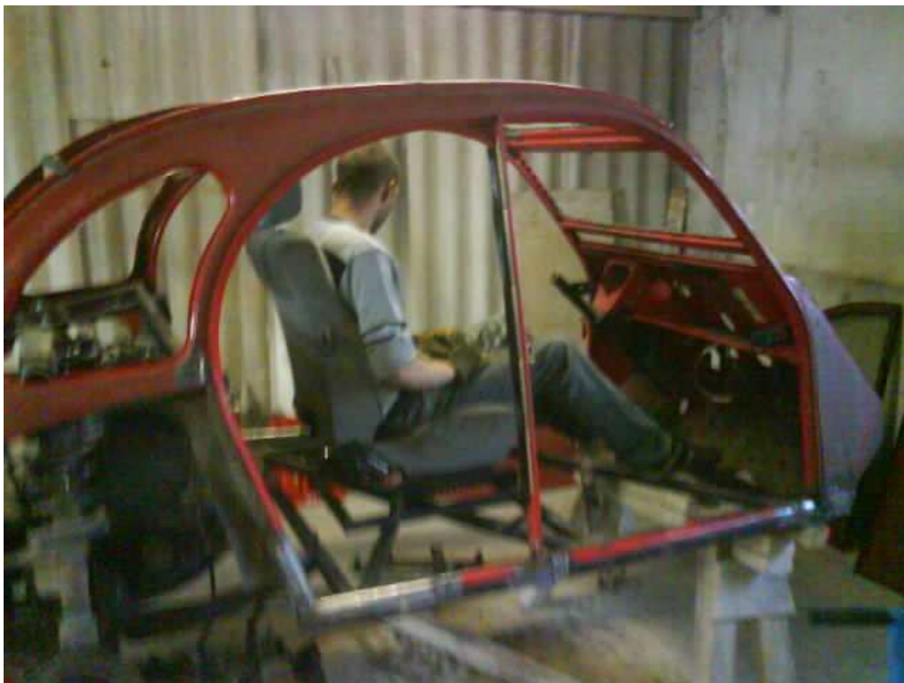
Die Sitzposition wurde in die Mitte des Fahrzeugs verlegt.
