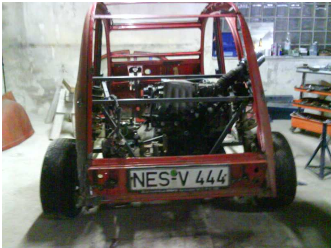
Motor und Getriebe wurden in den Kofferraum eingebaut.
